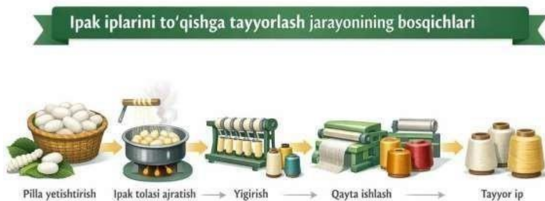
1-rasm. Ipak iplarini to'qishga tayyorlash jarayonining bosqichlari
